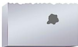
Łóżysko nieuszkodzone z mocnymi wtrąceniami
